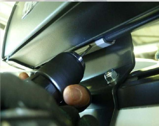
Ist die Markise positioniert, mit einem 3mm Bohrer die Löcher tief genug vorbohren. Da die schrauben recht zerbrechlich sind.
