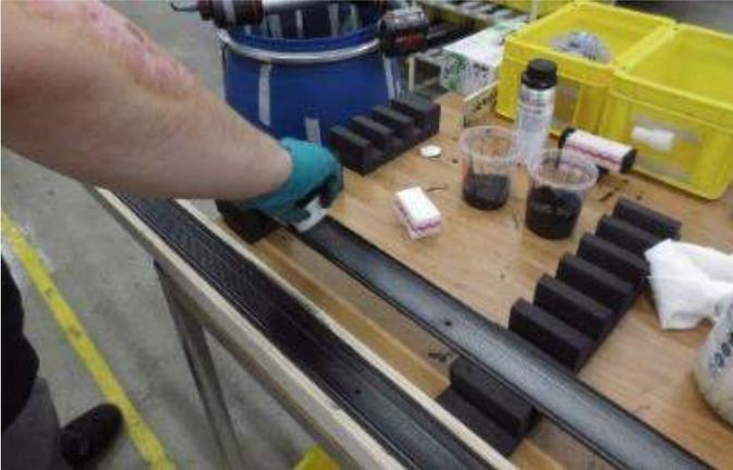
Die Schiene und die Halterungen reinigen! Dann mit Sika 207 primern und anschließend Klebstoff auftragen
