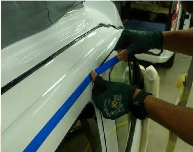
Mit einem Wasserdichten Klebeband, ( bei uns das 3m Band 471) ca.5mm oberhalb der Konturen abkleben. Damit kein Primer das Fahrzeug versaut und keine Reste nach der Montage sichtbar sind.
