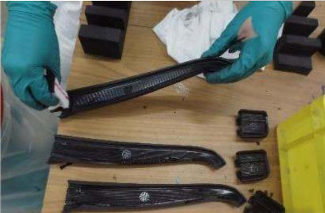
Kleine Endkappe reinigen und mit Sika 207 primern. Für 10Min stehen lassen, Ref: 2700213
