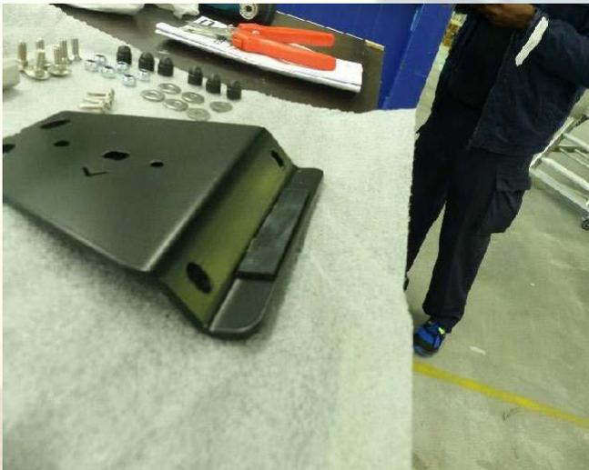
Die Halter mit Isopropylalkohol reinigen und die mitgelieferten Unterlagen drauf verkleben.
