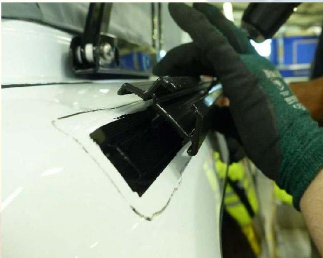
Die Schiene mit den Schrauben Art.-Nr. 3079132 in die vorgebohrten Löcher schrauben.
